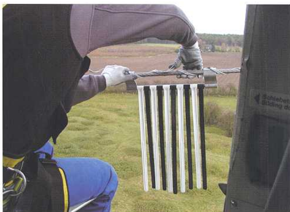
Chaque marquage est fait d'une suite de lamelles mobiles accrochées à une structure en aluminium. Il peut être accroché sur le câble de protection contre la foudre de la ligne aérienne et attaché avec deux spirales d'aluminium. Photo Thomas Müller.
